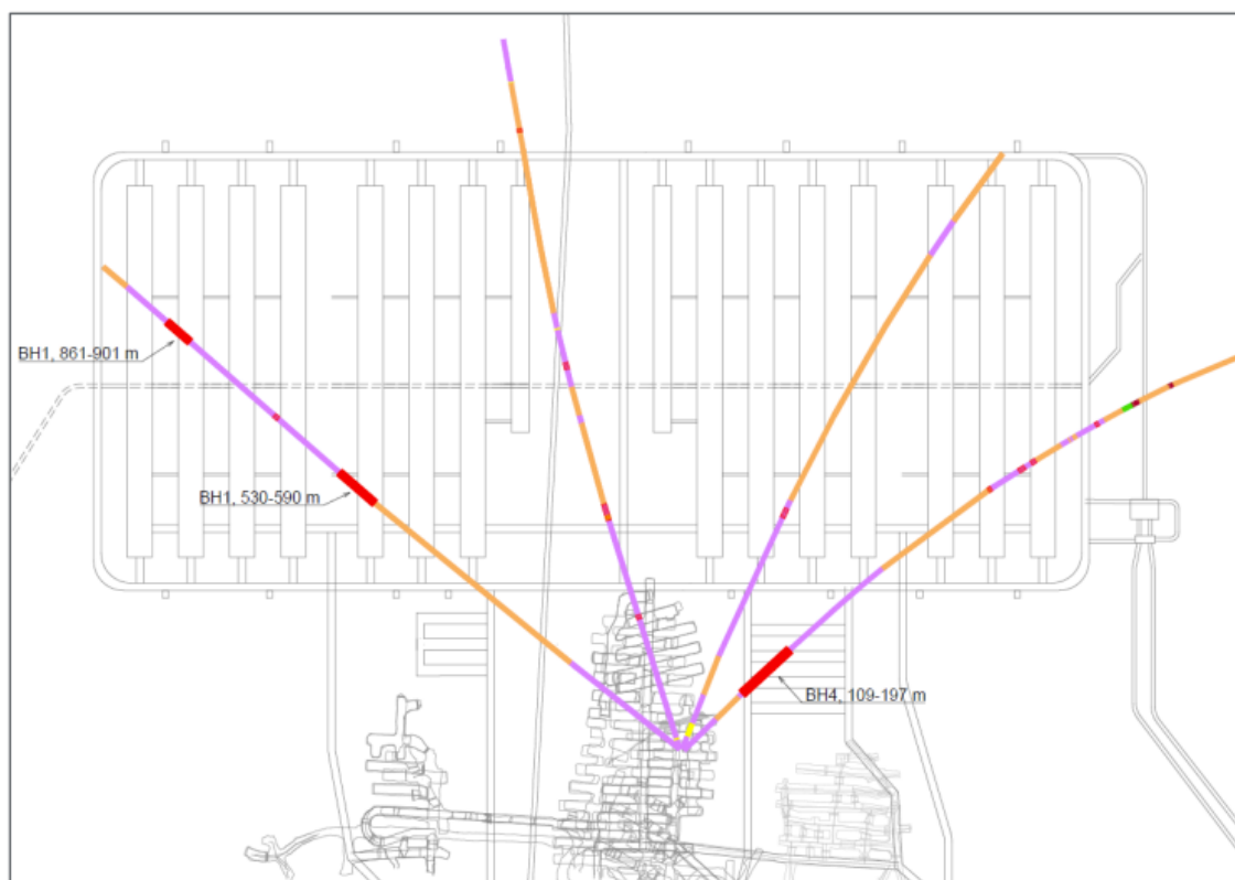
Figur 3-6: Illustrasjon over kjerneboringsresultat som viser soner med særleg dårlege eigenskapar med raud farge og peridotitt med lilla farge (5).
