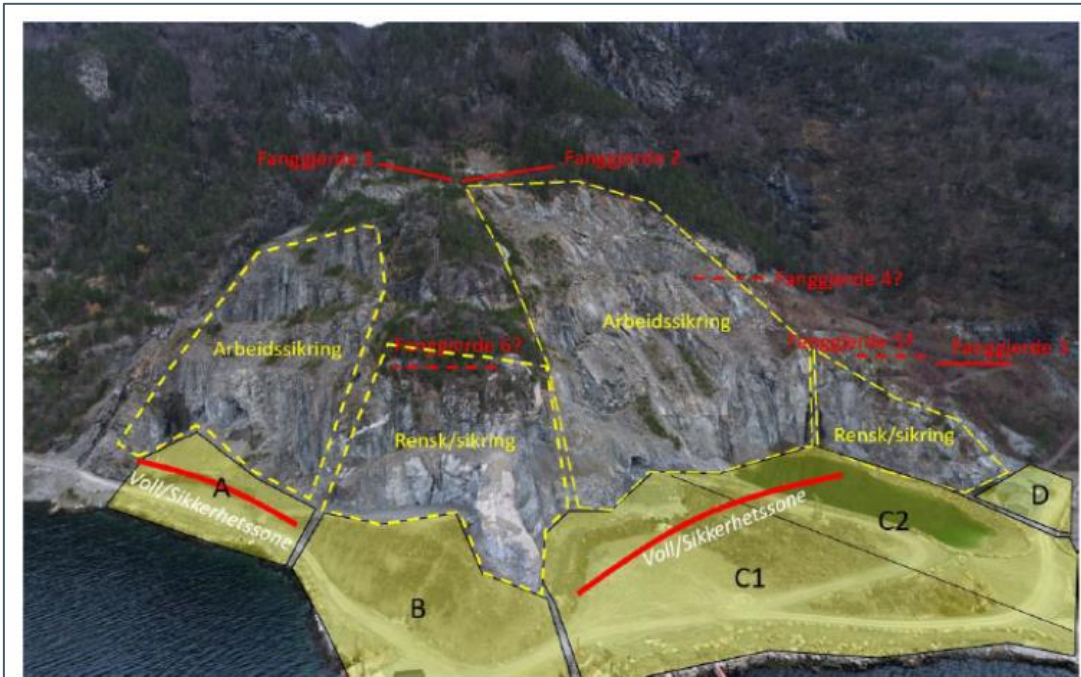
Figur 35: Oversikt over deler av vurdert område og anbefalte sikringstiltak.
